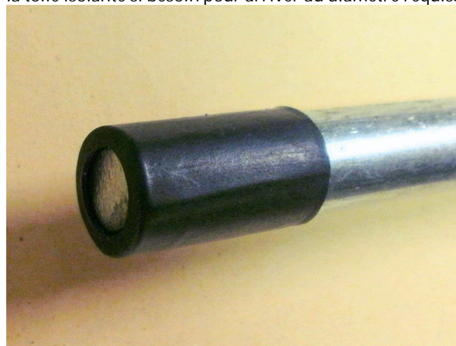
La gaine thermorétractable vient d'être chauffée. L'ensemble est toujours sur son mandrin
