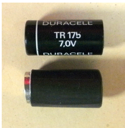
La pile d'origine et celle que nous vous proposons de réaliser
