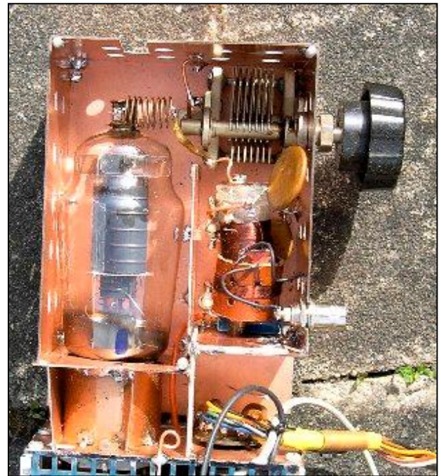
En dessous, vue de l'intérieur : dans le coin supérieur gauche, on peut voir un condensateur électrolytique. A sa droite, une lampe subminiature (cadeau de Henri F8BK). Il y en a une autre à droite du compartiment suivant. En dessous des chimiques, les deux collerettes grise sont le haut de transfos BF professionnels (donnés par Alex ON4AY). Le tout est monté en Manhattan.
